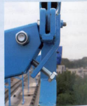
De monorail wordt waterpas gezet met stelbouten.
