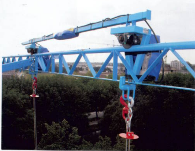
De horizontale aandrijving middels twee elektromotoren.
